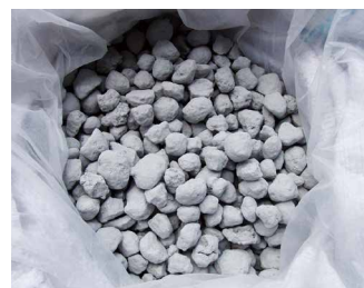
ヘドロが堆積した海底の環境を改善する石灰灰造粒物。
