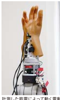
計測した筋電によって動く電動義手
