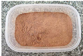
ユーカリ粉砕物 水熱前処理をする前のもの。木片を粉々にしてバッチ式 のオートクレープリアクターにかけます。
