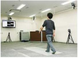
三次元動作解析装置の前を実際に歩いてみました。体に小さな粒のようなマーカーを付け、体の動きを3D映像にして解析するそうです。
