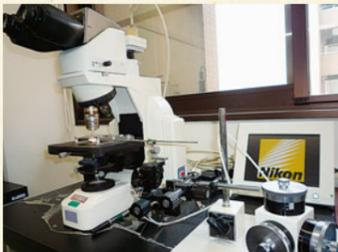
顕微鏡(マイクロナュビレーター) 直接見ながら酵母を移動できる装置
