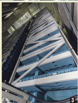
1.このレールで図書が運ばれてきます 2.図書はジャンル別ではなくサイズ別にコンテナに収納されています。出庫ステーションで呼び出すと、求める図書を納めたコンテナが出庫口まで運ばれ、コンテナからは人が図書を取り出します 3.70万冊以上を収納できる書庫棟
